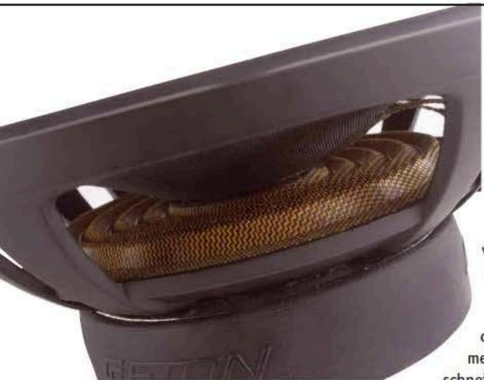
Die Verbundmembran des 16er wird von einer Zentrierspinne aus Mischgewebe im Zaum gehalten
