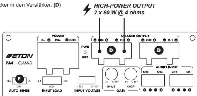
**Info:** Kanal 4/3 sind mit 2 x 80 W RMS ausgestattet & sogenannte „High-Power Ausgänge“. Diese können für leistungsintensive Lautsprecher verwendet werden.
